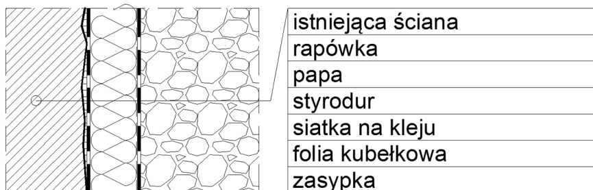
Detal 1 - przekrój warstw hydroizolacji ściany piwnicy
